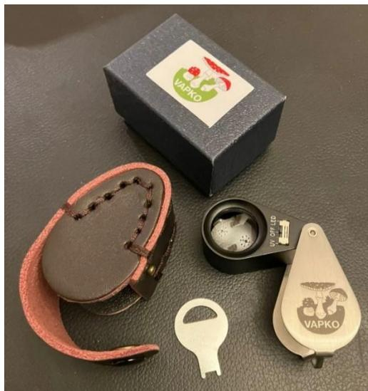
Une nouvelle loupe de détermination a été ajoutée à la boutique. Dotée d'un double éclairage à lumière blanche ou UV, elle offre un grossissement de 10x grâce à une optique triplet, qui combine trois lentilles pour minimiser les déformations et garantir des observations précises.
